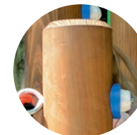
Rondhouten palen buiten het hart gezaagd - aan het uiteinde is elke paal netjes afgekort en gekruind
